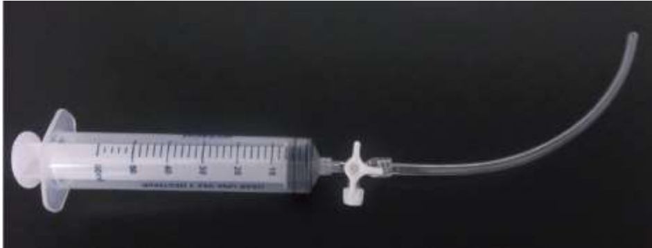
Figura N° 5: Jeringa de 50 ml acoplada a una llave de tres vías y una manguera de 40 cm
