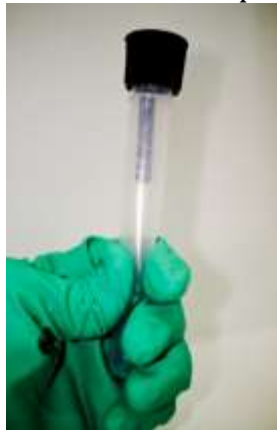
Figura N° 19: Forma de romper las capsulas de vidrio con solución de reactivos
