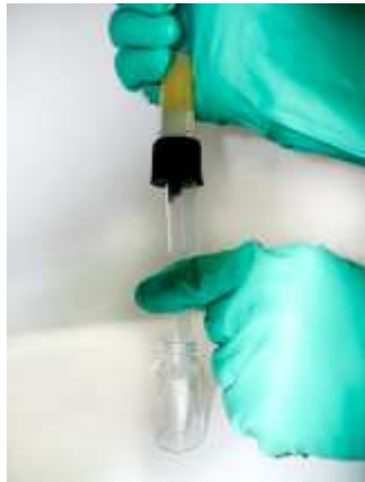
Figura N° 16: Traspaso de solución a frasco de medición con el electrodo
